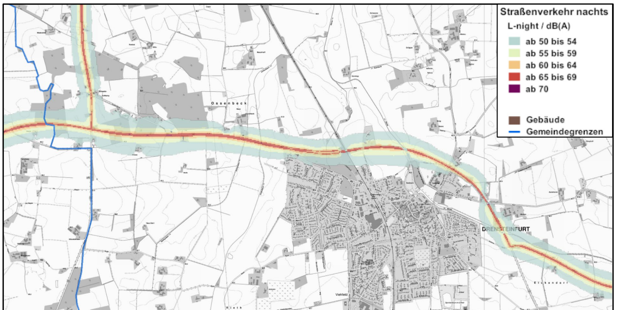
Karte 4: Isophonenkarte Nacht L_{night} (8 Stunden) für Drensteinfurt (B 58) genordet, ohne Maßstab (Auszug aus Anlage 3)
